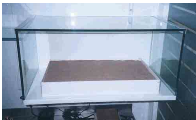
El espesor de la capa de arena debe ser superior a 6 cms.
